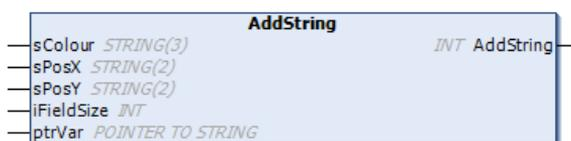
Рисунок 2.5 – Графическое представление метода *AddString*
