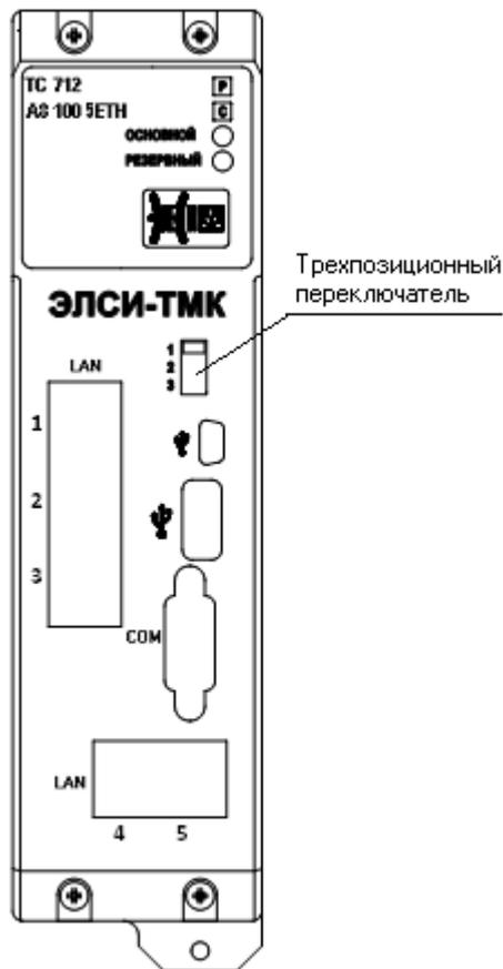
Рисунок 4 – Лицевая панель модуля. Трехпозиционный переключатель
