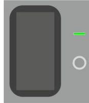
3.3.2.1 Включить сетевой выключатель на лицевой панели источника питания контроллера. На лицевой панели источника питания должен включиться индикатор "+24 V" и начаться инициализация центрального процессора и модулей контроллера.
