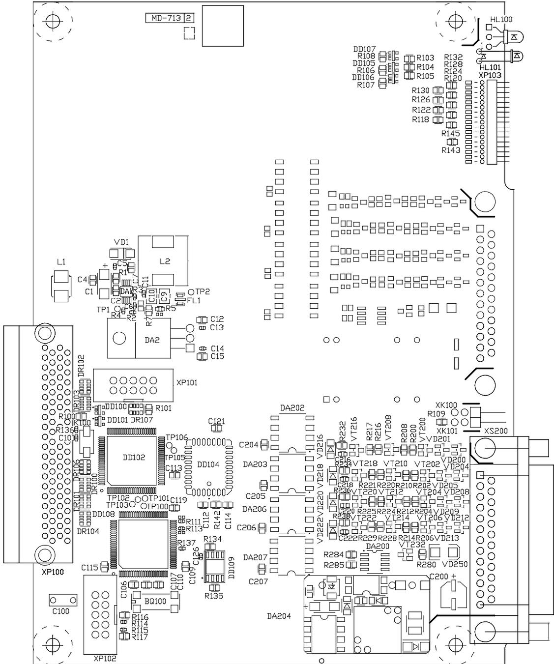
Рисунок В.1 – Схема размещения элементов на печатной плате модуля
