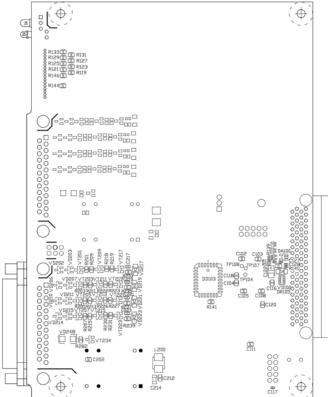
Рисунок В.2 – Схема размещения элементов на печатной плате модуля исполнения TD 713 8I CNT (обратная сторона)
