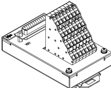
Выносной клеммный блок TB713DS с защитными функциями
