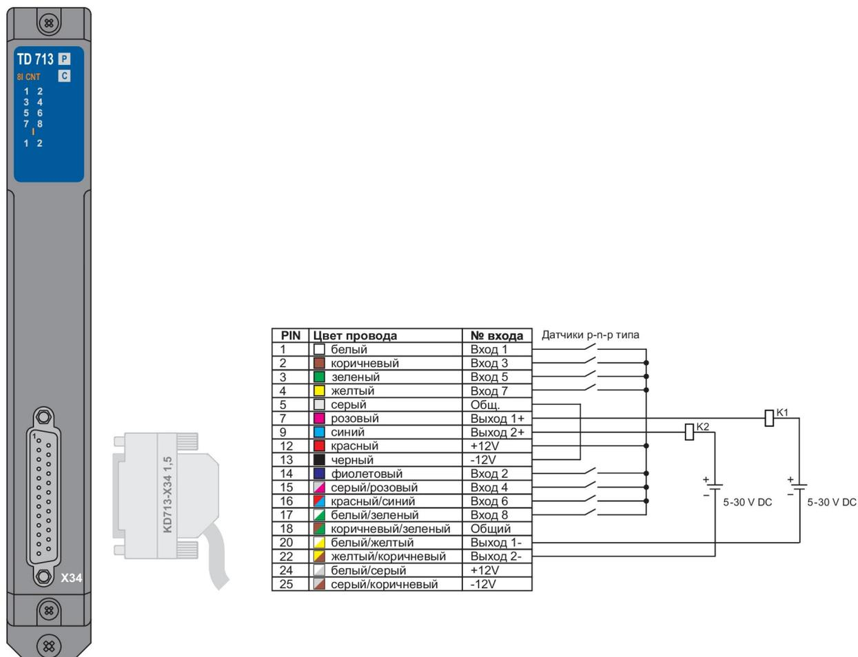
Рисунок 3 – Схема подключения датчиков р-п-р типа
