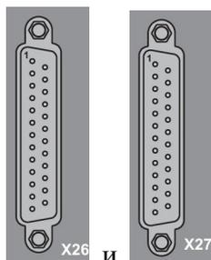
— к разъёмам X26 и X27 модуля исполнения TD 713 16I CNT, соответственно, с помощью кабелей KD713-X26 и KD713-X27.
