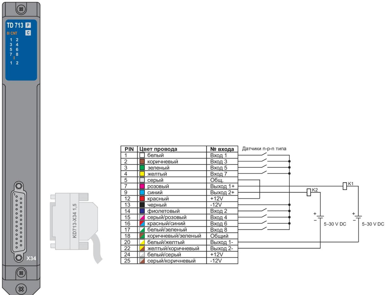
Рисунок 2 – Схема подключения датчиков п-р-п типа
