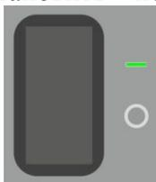
выключатель на модуле источника питания контроллера. На лицевой панели источника питания должен светиться индикатор "+24 V", должна начаться инициализация центрального процессора и модулей контроллера.
