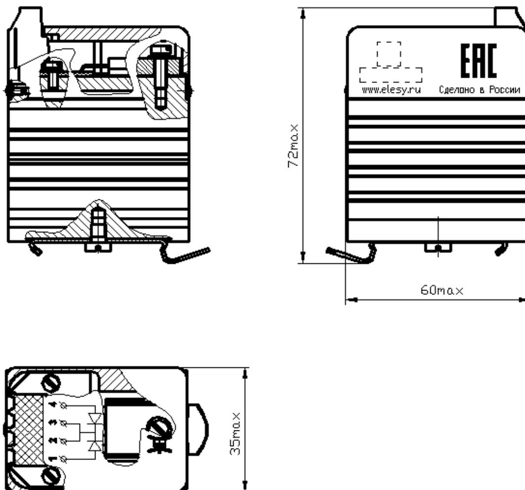
Рисунок А.1 – Габаритный чертеж модуля EF R 24DC/24DC-20 С
