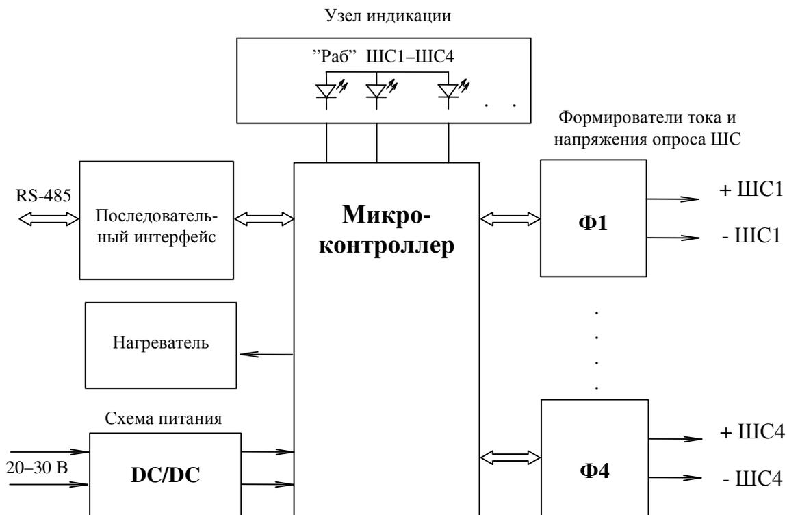
Рисунок 1 – Структурная схема электронного блока сигнализатора МС-АП-01
