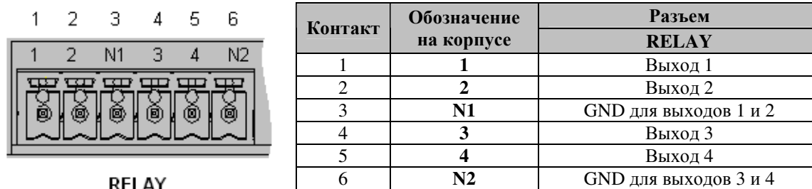
Рисунок 1.10 – Назначение контактов разъема "RELAY"
