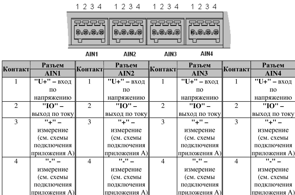
Рисунок 1.15 – Назначение контактов разъемов AIN1-AIN4
