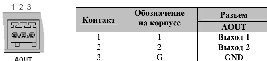
Рисунок 1.14 – Назначение контактов разъема AOUT
