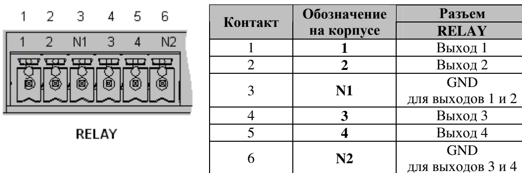
Рисунок 1.10 – Назначение контактов разъема "RELAY"
