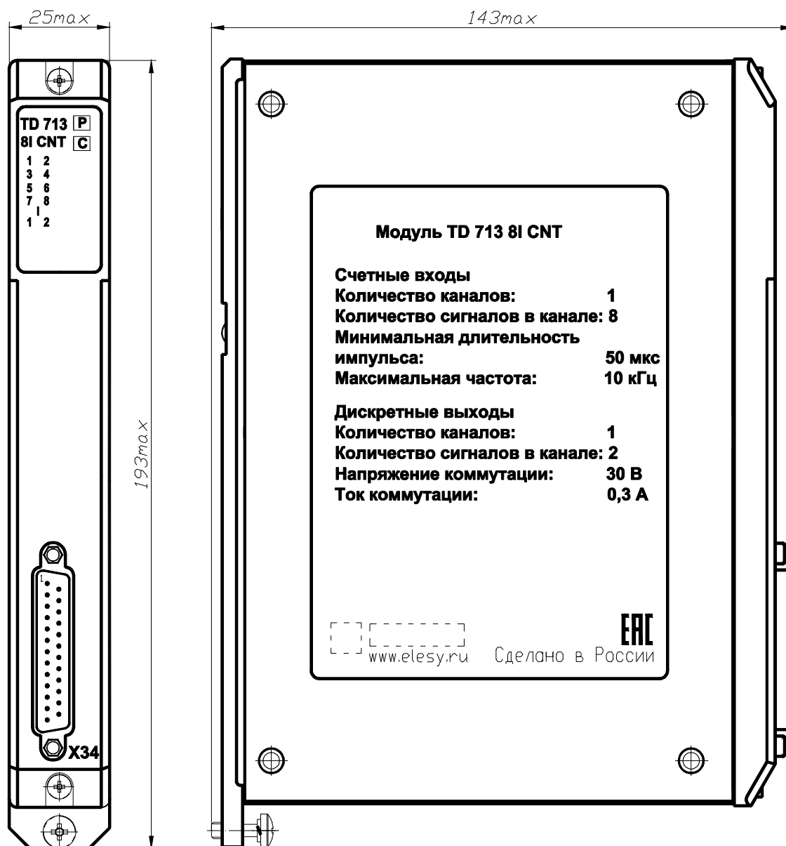
Рисунок А.1 – Габаритный чертеж модуля исполнения TD 713 8I CNT
