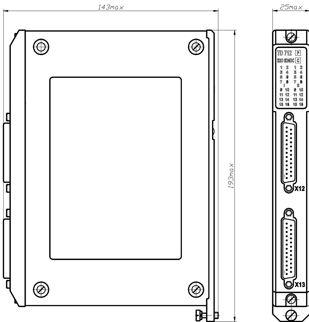
**Рисунок А.1 – Внешний вид и габаритные размеры модуля TD 712**
