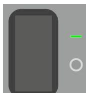
5.1 Включить сетевой выключатель на модуле источника питания контроллера. На лицевой панели источника питания должен включиться индикатор "+24 V", должна начаться инициализация центрального процессора и модулей контроллера.
