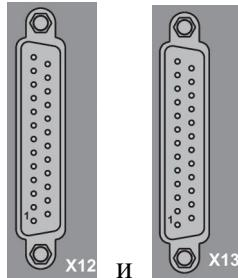
4.3.2 Подключить к разъемам X12 и X13 модуля цепи сигналов. Назначение
