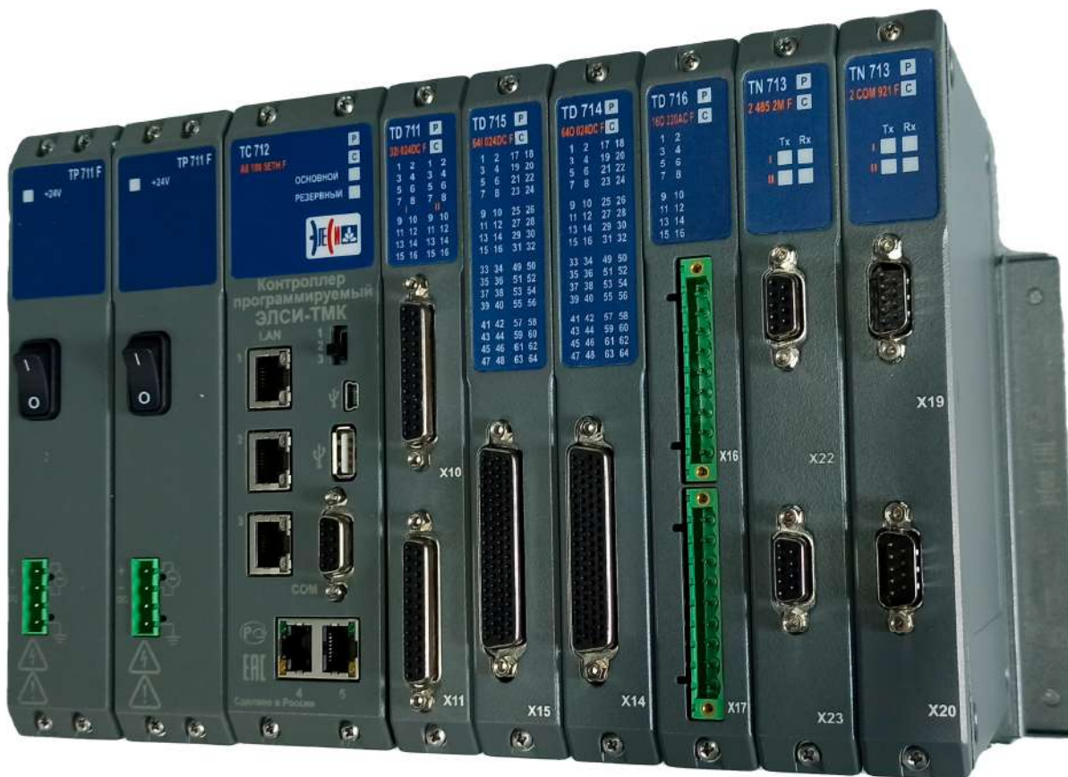
Рисунок 1.1 – Внешний вид ПЛК ЭЛСИ-ТМК
