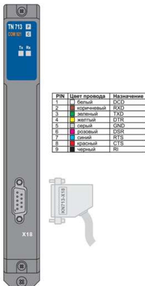
Рисунок 2.102 – Назначение контактов разъёма кабеля "KN713-X18" для модуля TN 713 COM 921
