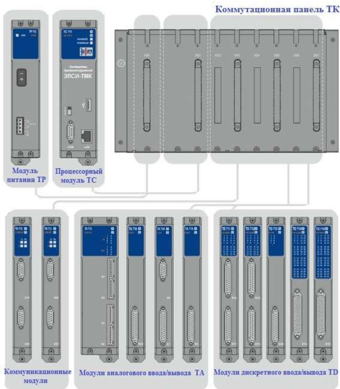
Рисунок 1.2 –Схема размещения модулей на коммутационной панели
